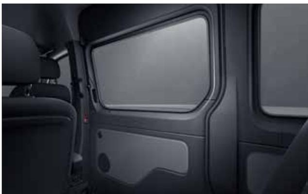
La porta scorrevole destra totalmente rivestita al suo interno con pannelli in materiale sintetico impreziosisce il look del vano passeggeri e del vano di carico.
