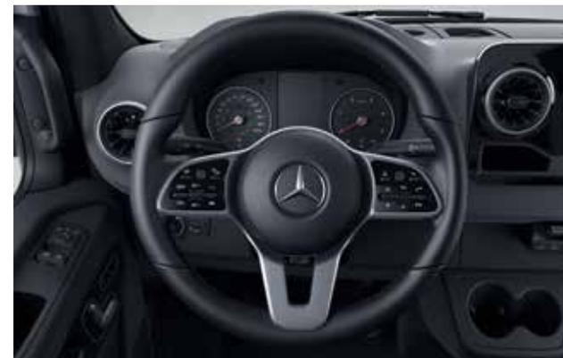
Dal volante multifunzione, il computer di bordo, le funzioni del veicolo e i sistemi multimediali possono essere comodamente comandati tramite pulsanti o tasti Touch Control, senza allontanare le mani dal volante.
