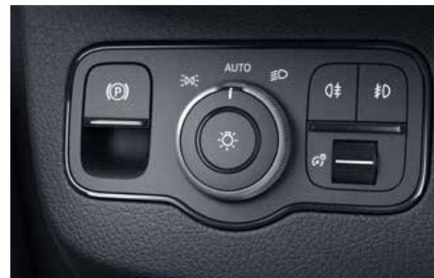
Il freno di stazionamento elettrico può essere semplicemente e comodamente azionato tramite la pressione di un tasto; la soppressione della leva del freno di stazionamento consente un passaggio più agevole verso il retro.
