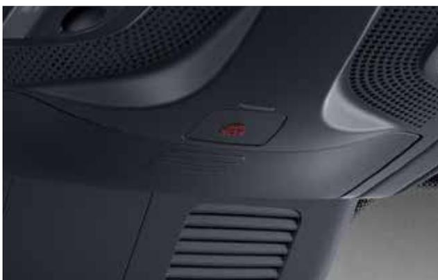
In caso di incidente, il sistema di chiamata di emergenza Mercedes-Benz stabilisce automaticamente una connessione telefonica di emergenza contribuendo a ridurre in misura decisiva il lasso di tempo fino all'arrivo dei soccorsi sul luogo dell'incidente.
