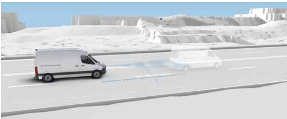
Il sistema di assistenza attivo alla regolazione della distanza DISTRONIC è in grado di mantenere la distanza dal veicolo che precede impostata dal conducente, alleviandone la fatica, per esempio in autostrada o nel traffico stop-and-go.
