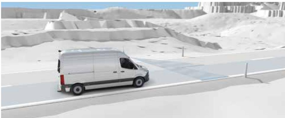
Il sistema antisbandamento attivo è in grado di individuare un involontario abbandono della corsia di marcia, segnalandolo al guidatore ed eventualmente riconducendo il veicolo nella sua traiettoria mediante interventi frenanti attivi.
