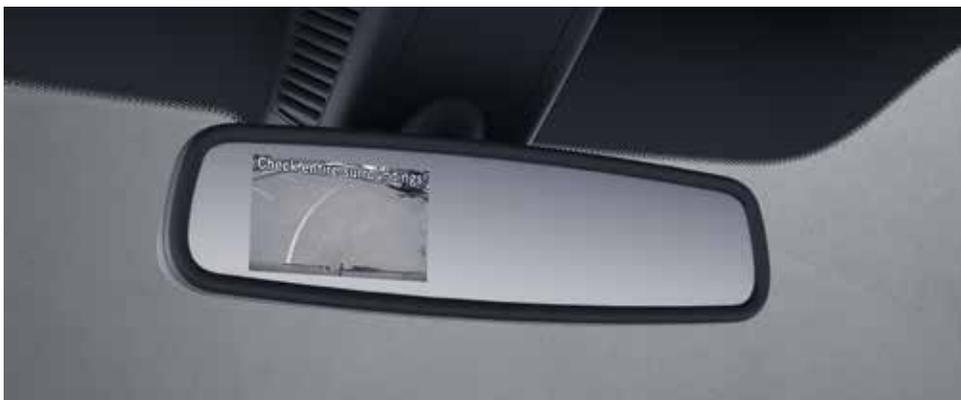
La telecamera per la retromarcia assistita con display nel retrovisore interno migliora la visibilità della zona immediatamente retrostante il veicolo e aumenta la sicurezza durante la retromarcia.
