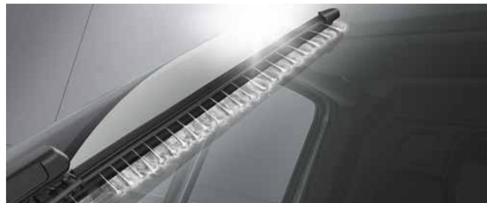
L'impianto tergicristallo WET WIPER SYSTEM<sup>1</sup> assicura al guidatore la migliore visibilità possibile anche quando i tergicristalli sono in funzione.
