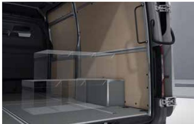
Il rivestimento in legno delle sedi di montaggio delle ruote migliora la possibilità di utilizzo del vano di carico e protegge la lamiera da possibili danni.
