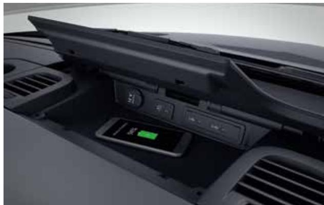
Il sistema wireless permette di caricare con grande semplicità i dispositivi mobili che supportano lo standard Qi 1.2 - o equipaggiabili a posteriori in tal senso - nel vano portaoggetti in alto al centro nella consolle centrale.
