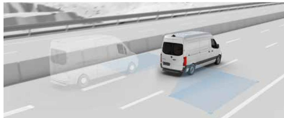
Il Blind Spot Assist con Rear Cross Traffic Alert può aiutare, tramite segnali di avvertimento ottici e acustici, a prevenire gli incidenti durante i cambi di corsia e nelle fasi di uscita in retromarcia dai parcheggi e di discesa dal veicolo.
