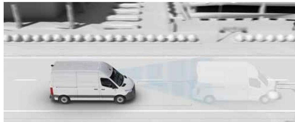
Il sistema di assistenza alla frenata attivo può contribuire a evitare le collisioni con i veicoli che precedono e con i pedoni che attraversano la carreggiata ed eventualmente attenuare la gravità delle conseguenze.
