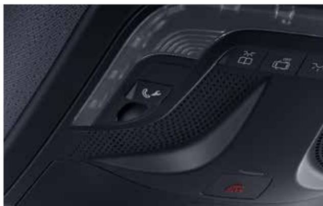
Soccorso stradale immediato, con la semplice pressione di un tasto: il servizio Gestione Guasti stabilisce una connessione vocale con il Customer Assistance Center (CAC) permettendo il soccorso rapido in loco.
