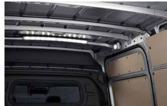
Due listelli luminosi a LED applicati sotto il tetto illuminano il vano di carico senza praticamente produrre ombra e migliorano così la visibilità durante le operazioni di carico e scarico.
