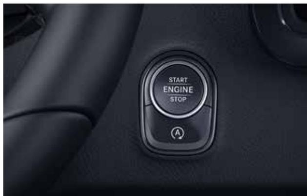
Avviamento del motore con la semplice pressione di un tasto: il sistema di abilitazione all'avviamento KEYLESS-START permette di avviare il motore limitandosi a premere il tasto start/stop situato nel blocchetto di accensione.
