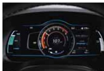
Strumentazione digitale a doppia modalità. La strumentazione digitale fornisce importanti informazioni tra cui il flusso di energia, lo stato di carica della batteria e informazioni di guida Eco Drive in entrambe le modalità, ECO e Sport.
